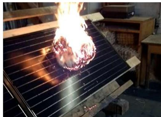
Abbildung 1: Prüfung Widerstand gegen Flugfeuer und strahlende Wärme
